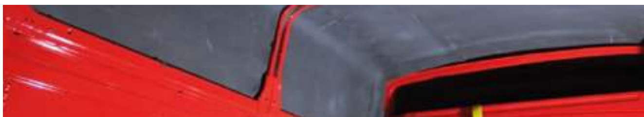
Techo de furgó ,Kaiflex Ductplus utilizado para camperizar.
