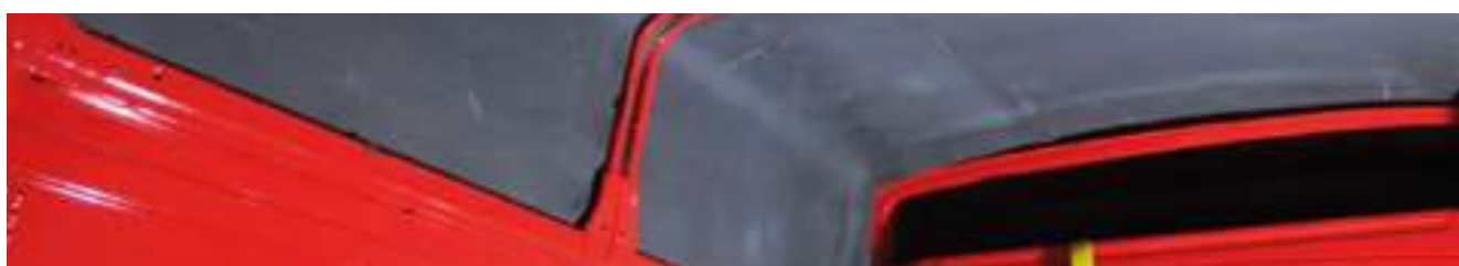
Techo de furgo ,Kaiflex Ductplus utilizado para camperizar.
